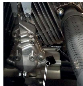
пробка маслосливного отверстия картера двигателя
